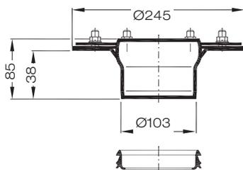
**Aufsatzelement mit Muffe**
